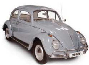
VW Käfer, BJ 1955, 730kg, 30PS, 110km/h, 7,5L/100km
